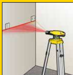
◀ Nivelación y alineación horizontal y vertical
