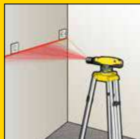
◀ Nivelación y alineación horizontal y vertical
